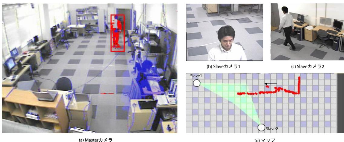
図 5.10: 追尾カメラシステムの動作例
