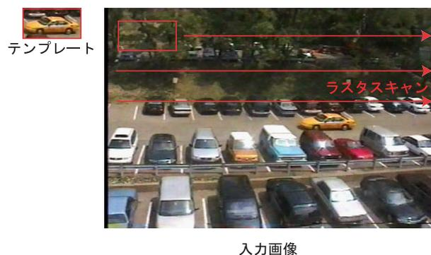
図 4.3: テンプレートマッチングの例
