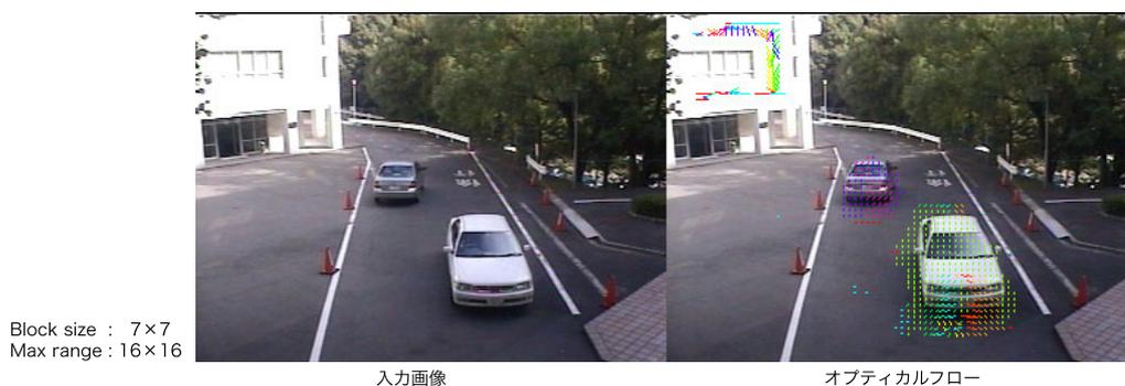
図 2.26: ブロックマッチング法により推定されたオプティカルフロー
