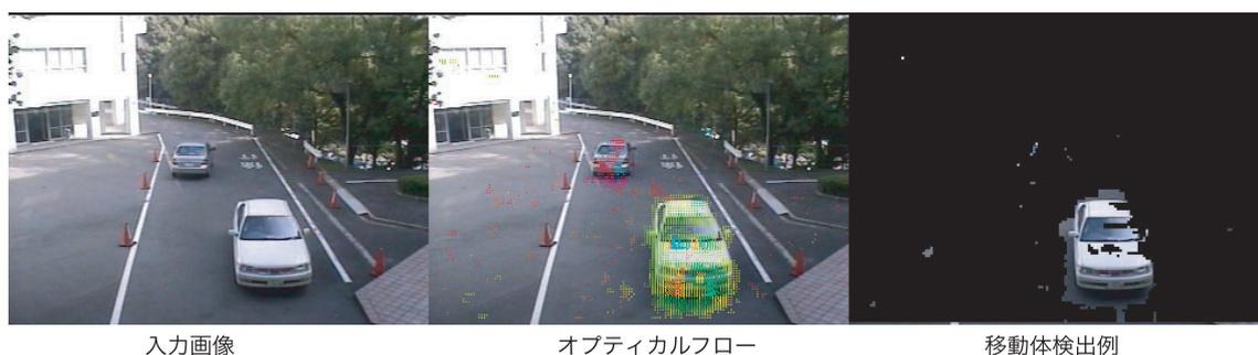
図 2.28: オプティカルフローを用いた移動体検出の例
