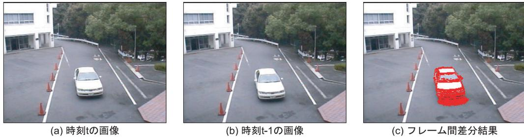
図 2.4: カラー画像をグレースケールに変換してフレーム間差分した結果
