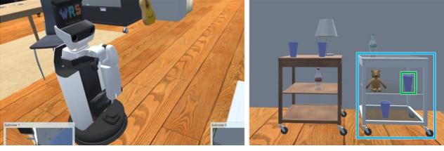
図 1: 左: 生活支援ロボットが把持対象物体を観察する例. 右: ロボットから得られるカメラ画像の例. 緑, 青の線はそれぞれ Target (blue glass), Source (metal wagon) のバウンディングボックスである. 把持命令文の例: “Bring me the blue glass on the same level as the teddy bear on the metal wagon.”
