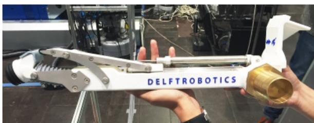
図 5 Delft のロボットのエンドエフェクタ。
