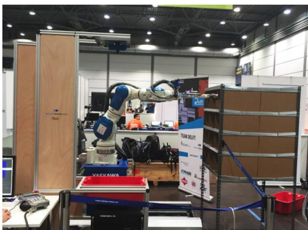
図 4 Delft (オランダ) のロボット。アーム部分に固定しているカメラから Tote 内のアイテムを認識して、細長い吸着ハンドでアイテムを把持する。
