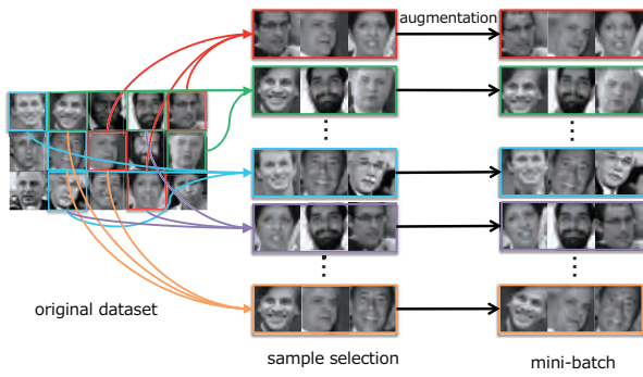
図4 Random mini-batch によるサブセット作成方法
