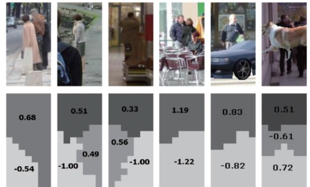
図 11 Wang らの手法による隠れ推定の結果 [22] . 上段は入力画像, 下段は隠れの推定結果を表わしている . 数字は人クラスの尤度を表わし, 数字が小さいほど隠れ領域の可能性が高い .
