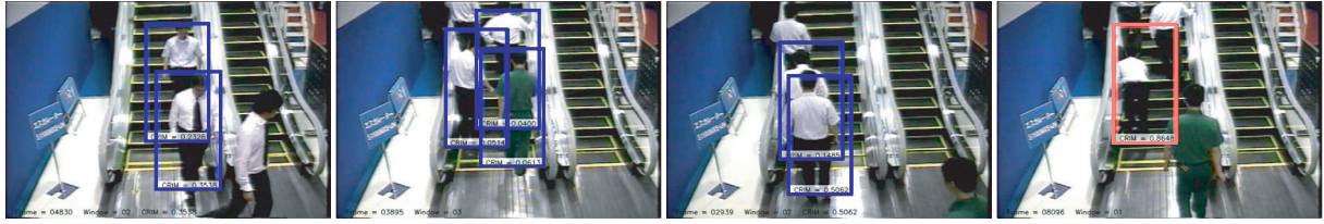
図 10: 提案手法による複数人の異常行動検知例
