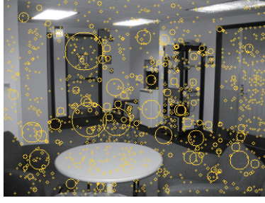
(b) エッジ上のキーポイントを削除 (キーポイント候補 1197 点)
