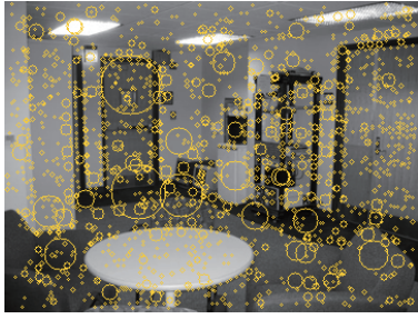
(a) 全キーポイント候補点 (キーポイント候補 1895 点)
